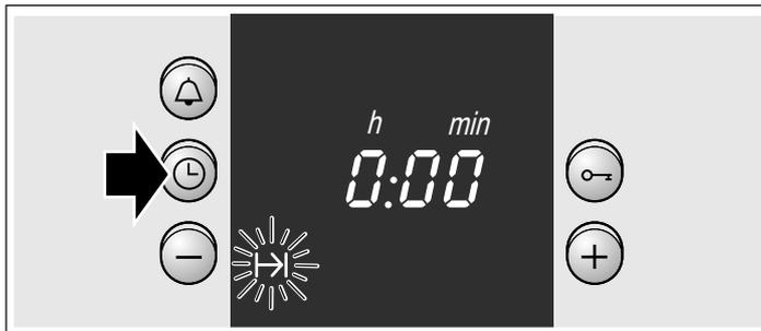
4. Met de toets + of de toets - de tijdsduur instellen. De toets + voorgestelde waarde = 30 minuten
