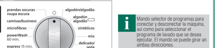
7. Mando selector de programas para conectar y desconectar la máquina, así como para seleccionar el programa de lavado que se desea ejecutar. El mando se puede girar en ambas direcciones.
