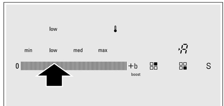
Le mode poêlées et grillades est alors activé. Le témoin de température **!** reste allumé jusqu'à ce que la température de friture soit atteinte. Un signal retentit et le symbole de température s'éteint.
