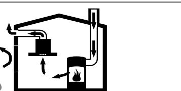
Vuurbronnen die de lucht in de ruimte verbruiken (bijv. apparaten die op gas, olie, hout of kolen worden gestookt, geisers, warmwaterkasten) trekken de verbrandingslucht uit de opstellingsruimte en voeren de gassen via een afvoer (bijv. schoorsteen) af naar buiten.
