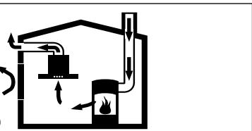
Raumluftabhängige Feuerstätten (z.B. gas-, öl-, holz- oder kohlebetriebene Heizgeräte, Durchlauferhitzer, Warmwasserbereiter) beziehen Verbrennungsluft aus dem Aufstellraum und führen die Abgase durch eine Abgasanlage (z.B. Kamin) ins Freie.
