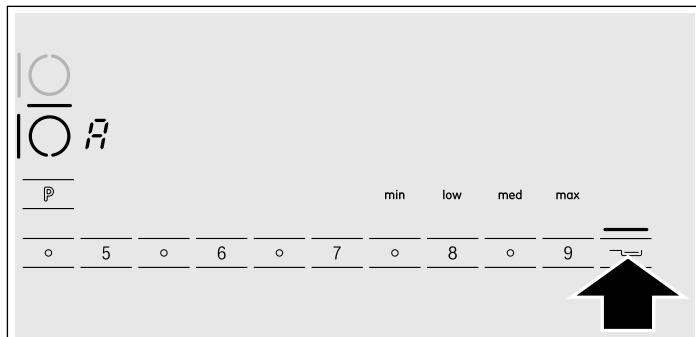
2. В течение следующих 10 секунд нажатием соответствующего символа степени нагрева выберите нужный температурный режим (см. рисунок). Функция жарения включена.
