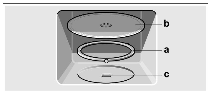
**Merk:** Apparatet må bare brukes når dreietallerkenen er satt inn. Kontroller at den er satt riktig på plass. Dreietallerkenen kan rotere mot høyre eller mot venstre.
