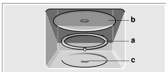
**Bemærk:** Anvend kun apparatet med indsæt drejetallerken. Kontroller, at den er gået korrekt i indgreb. Drejetallerkenen kan drejes både mod venstre og mod højre.
