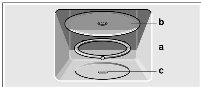
**Huomautus:** Käytä laitetta vain pyörivä lautanen paikalleen asennettuna. Varmista, että se on lukittunut oikein paikalleen. Pyörivä lautanen voi pyöriä sekä vasemmalle että oikealle.
