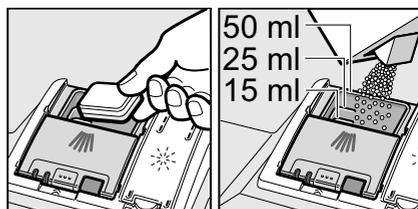
2. Chiudere il coperchio del contenitore detersivo spingendolo in alto, fino al corretto innesto del dispositivo di chiusura.
