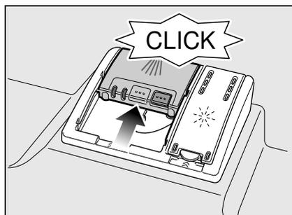
Il contenitore detersivo si apre automaticamente in funzione del programma, al momento opportuno. Il detersivo in polvere o liquido si distribuisce nell'apparecchio e si diluisce. Il tab cade nella vasca e qui si scioglie.
