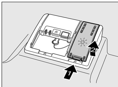
2. Introdurre con precauzione brillantante fino al riferimento max. dell'apertura di riempimento.
