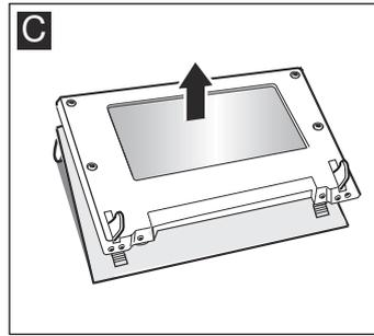
Die demontierten Teile dürfen nicht gewaschen werden. Reinigen Sie die Scheiben mit einem Glasreiniger und einem weichen Tuch.
