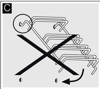
2. Die zwei Haken müssen vollständig in den oberen Löchern eingehängt sein. Jetzt das Gestell langsam und vorsichtig nach unten bewegen und in die unteren Löcher eingehängen (Abbildung D).
