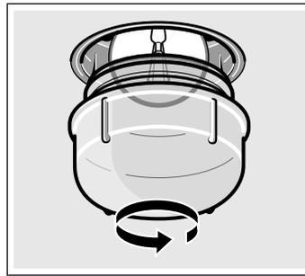
3. Lampe durch den gleichen Lampentyp ersetzen.
