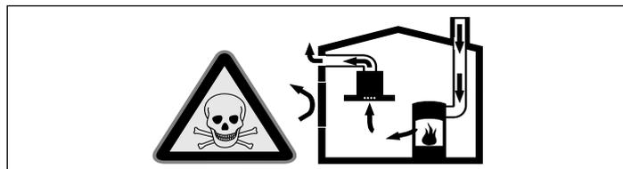
Uzavřené spotřebiče paliv (např. tepelné spotřebiče na plyn, olej, dřevo nebo uhlí, průtokové ohříváče, bojler) odebírají spalovací vzduch z místnosti, ve které jsou nainstalované, a spaliny odvádějí zařízením pro odvod spalin (např. komínem) ven.
