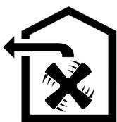
Nasávaný vzduch se čistí tukovým filtrem a systémem trubek se odvádí ven.
