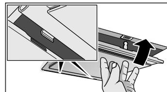
Ak ide o prídavné filtre vo vnútri, otvorte zabezpečovací mechanizmus a tukový kovový filter sklopte. Pritom druhou rukou chyťte tukový kovový filter zdola.
