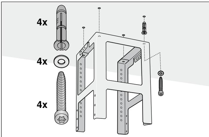
4. Pro upevnění vyvrtejte čtyři otvory o  $\varnothing$  8 mm a hloubce 80 mm a zatlačte do nich hmoždinky tak, aby byly v jedné rovině se stěnou.
