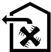
Nasávaný vzduch sa prechodom cez tukový filter prečistí a odvádza sa cez potrubný systém von.
