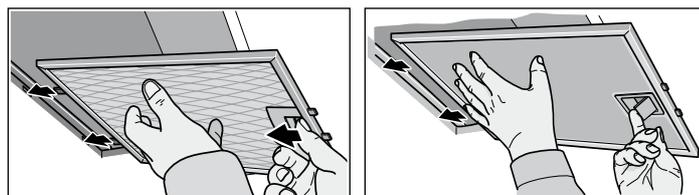
U filtrů s obvodovým odsáváním vytáhněte kovový tukový filtr dolů. Při tom přidrže kovový tukový filtr zespodu druhou rukou.
