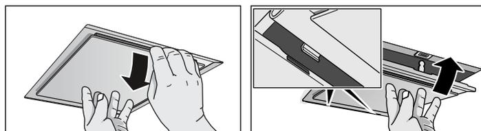
U přídavných filtrů ve vnitřním prostoru odjistěte aretaci a kovový tukový filtr vyklopte dolů. Při tom přidrže kovový tukový filtr zespodu druhou rukou.
