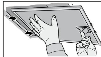
Ak ide o okrajové odsávacie filtre, tukový kovový filter potiahnite nadol. Pritom druhou rukou chyťte tukový kovový filter zdola.
