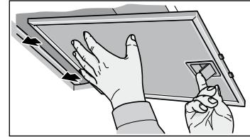
Servatõmbefunktsiooniga filtrite puhul tömmake metallist rasvafilter alla. Sealjuures hoidke teist kätt metallist rasvafiltri all.
