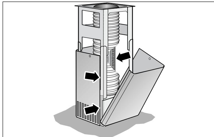
4. Viršutinę kamino dalį pastumkite į viršų ir pritvirtinkite 2 varžtais.
