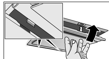
Jei prietaiso viduje yra papildomi filtrai, atidarykite sklendę ir metalinį riebalų filtrą atlenkite žemyn. Kita ranka prilaikykite metalinio riebalų filtro apačią.
