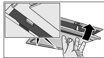
Ja korpusā ir uzstādi papildu filtri, atveriet aizvaru un atvāziet metāla filtru lejup. Vienlaikus ar otru roku satveriet zem metāla filtra.
