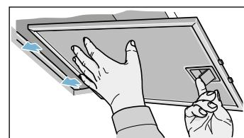
På kantfilter må du trekke metallfettfilteret nedover. Hold med den andre hånden under metallfettfilteret.
