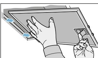
Ved filtre til kantsug skal metalfedtfiltret trækkes nedad. Hold samtidig med den anden hånd under metalfedtfiltret.
