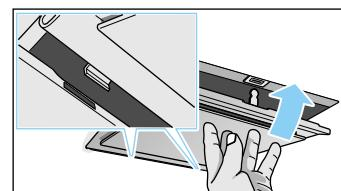
Finns det extrafilter inuti, öppna låsningen och fäll ned metallfiltret. Håll andra handen under filtret.
