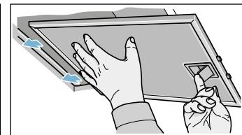
Jos kyseessä on reunamusuodatin, vedä metallista rasvasuodatinta alas päin. Pidä samalla toisella kädellä kiinni rasvasuodattimen pohjasta.
