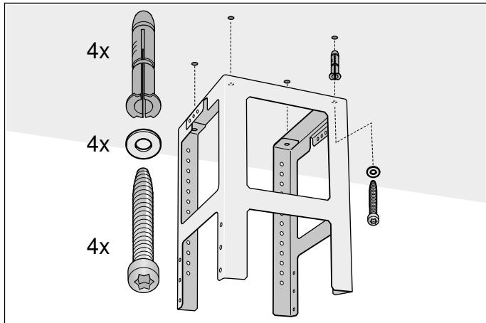
4. Bor fire hull med Ø 8 mm og boredybde 80 mm for feste og sett inn hylser i plan med boringen.
