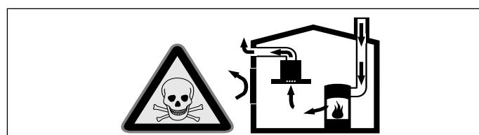
Huoneilmaa tarvitsevat tulisijat (esim. kaasu-, öljy-, puu- tai hiilikäyttöiset lämmityslaitteet, läpivirtauskumemmin, vedenkumemmin) ottavat polttoilman huonetilasta ja johtavat poistoilman poistoilmalaitteen (esim. savutorven) kautta ulos.
