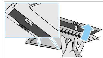
Ved ekstrafilter inne i apparatet må du åpne låsen og klappe ned metallfettfilteret. Hold med den andre hånden under metallfettfilteret.
