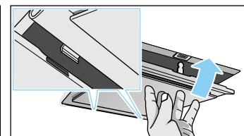
Jos sisäpuolella on lisäsuodattimet, avaa lukitus ja käännä metallinen rasvasuodatin alas. Pidä samalla toisella kädellä kiinni rasvasuodattimen pohjasta.
