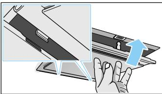
Ved ekstra indvendige filtre skal låseanordningen åbnes og metalfedtfiltret klappes ned. Hold samtidig med den anden hånd under metalfedtfiltret.
