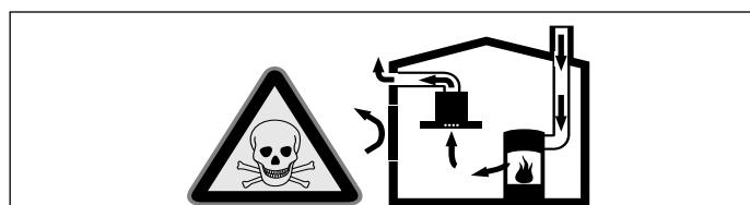
Eldständer som är beroende av rumsluft (t.ex. värmearrater som drivs med gas, olja, ved eller kol, genomströmningsapparater, varmvattenberedare) tar sin förbränningsslut ur det utrymme där enheten är installerad och leder ut avgaserna i det fria via en avgasanläggning (t.ex. skorsten).
