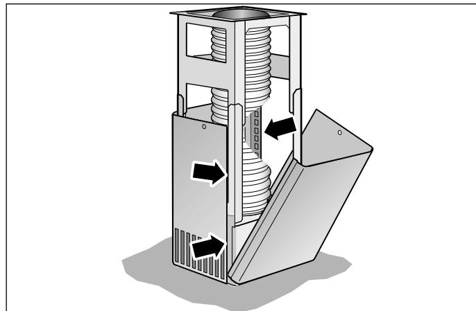
4. Skjut upp den övre kåpan och fäst med 2 skruv.
