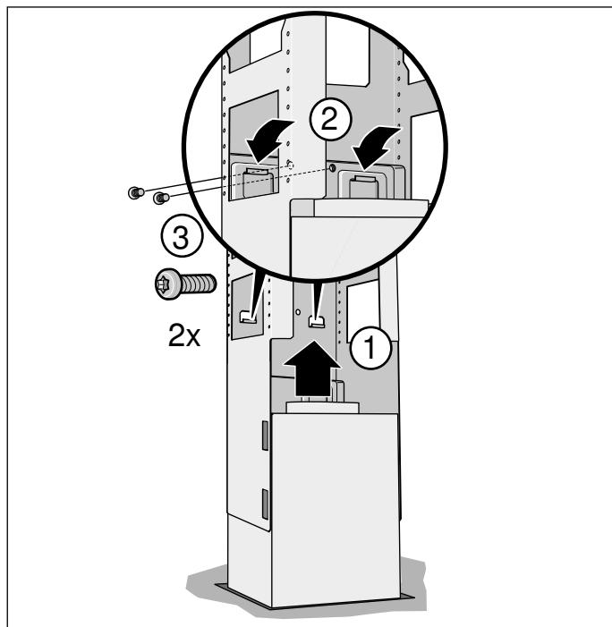
3. Aseta varmistimet paikoilleen ja kiinnitä ruuveilla.
