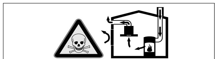
Ildsteder som er avhengig av romluft (f.eks. varmeapparater som drives med gass, olje eller kull, varmtvannsberedere) bruker forbrenningsluften fra oppstillingsrommet og leder avgassene gjennom et avgassanlegg (f.eks. pipe) i det fri.
