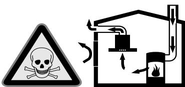
Eldständer som är beroende av rumsluft (t.ex. värmeapparater som drivs med gas, olja, ved eller kol, genomströmningsapparater, varmvattenberedare) tar sin förbränningsslut ur det utrymme där enheten är installerad och leder ut avgaserna i det fria via en avgasanläggning (t.ex. skorsten).
