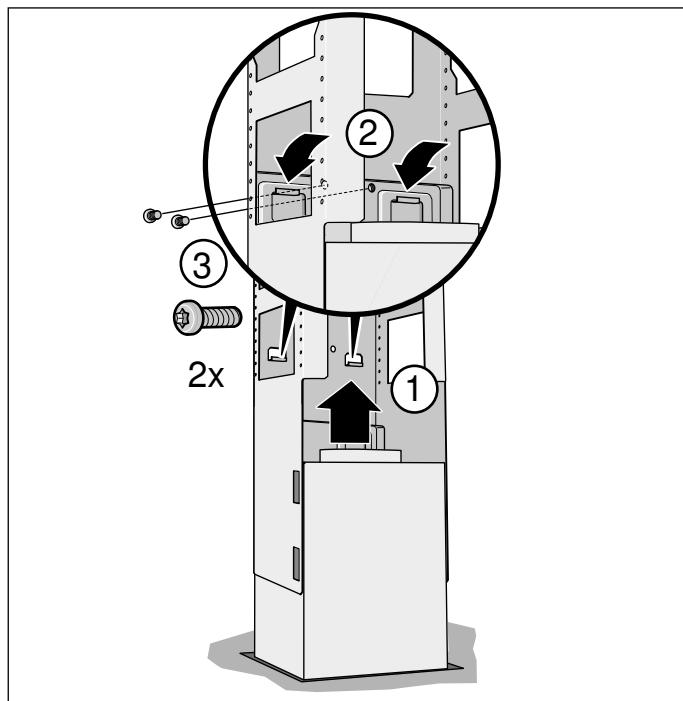
3. Sätt dit säkerhetsbyglarna och skruva fast dem.
