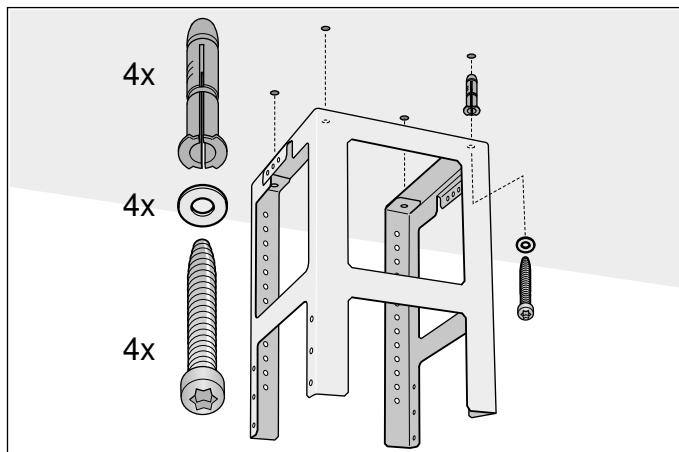
4. Bor fire huller med en diameter ( $\varnothing$ ) på 8 mm og en boredybde på 80 mm til fastgørelserne, og tryk dylerne ind, så de fluger med overfladen.
