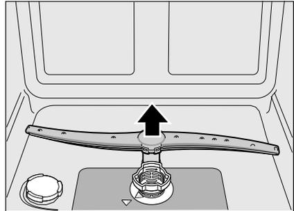
3. Sprüharm unter fließendem Wasser reinigen.
