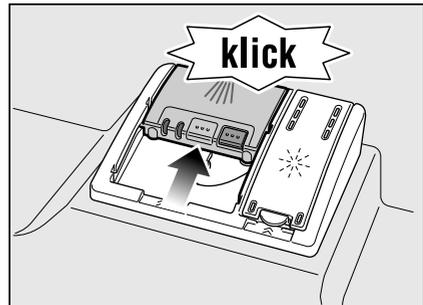
Die Reinigerkammer öffnet sich programmabhängig automatisch zum optimalen Zeitpunkt. Der Pulver- oder Flüssigreiniger verteilt sich im Gerät und wird aufgelöst. Der Tab fällt ins Gerät und löst sich dort auf.
