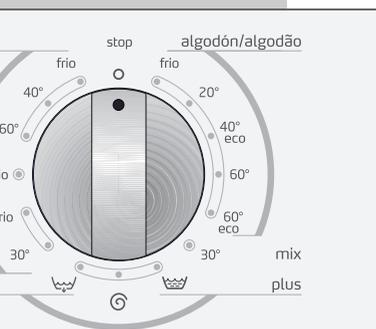
Mando selector de programas para conectar y desconectar la máquina, así como para seleccionar el programa de lavado que se desea ejecutar. El mando se puede girar en ambas direcciones.
