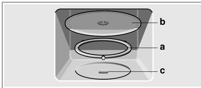
**Указание:** Используйте прибор со вставленной вращающейся подставкой. Проверьте, чтобы она была правильно зафиксирована. Вращающаяся подставка может вращаться как в левую, так и в правую сторону.
