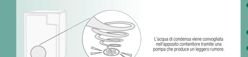
L'acqua di condensa viene convogliata nell'apposito contenitore tramite una pompa che produce un leggero rumore.
