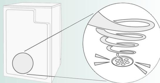
L'acqua di condensa viene convogliata nell'apposito contenitore tramite una pompa che produce un leggero rumore.
