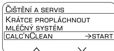
Během jednotlivých postupů calc'nClean bliká tlačítka **8 start**. Číslice vpravo nahoré zobrazují jednotlivé fáze programu.
