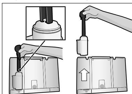
**Informacja:** Płukanie filtra włącza jednocześnie ustawienie dla wskazania wymiany filtra.
