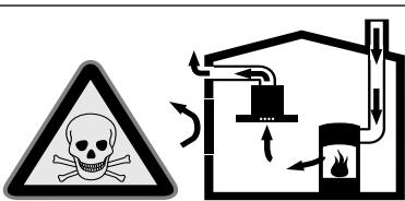
Raumlufthängige Feuerstätten (z.B. gas-, öl-, holz- oder kohlebetriebene Heizgeräte, Durchlauferhitzer, Warmwasserbereiter) beziehen Verbrennungsluft aus dem Aufstellraum und führen die Abgase durch eine Abgasanlage (z.B. Kamin) ins Freie.
