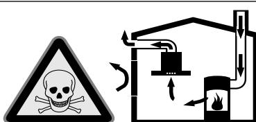
Ildsteder, hvis lufttilførsel sker fra indeluften, (f.eks. gas-, olie-, træ- eller kulfyrede varmeapparater, gennemstrømningsvandvarmere, vandvarmere) henter deres forbrændingsluft fra opstillingsrummet og fører røggassen ud gennem en røggaskanal(f.eks. skorsten) til det fri.
