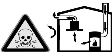
Huoneilmaa tarvitsevat tulisijat (esim. kaasu-, öljy-, puu- tai hiilikäytöiset lämmityslaitteet, läpivirtauskuumennin, vedenkuumennin) ottavat poltoilman huonetilasta ja johtavat poistoilman poistoilmalaitteen (esim. savutorven) kautta ulos. Tuuletin imkeelee lämmityslaitteesta ja sen viereiseen huoneesta ilmaa - tämä on korvattava riittävällä tuloilmallulla - muutoin syntyy alipaine. Myrkylliset kaasut imetytysivät takaisin huoneisiin savutorvesta tai poistoilmakanavasta.
