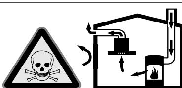
Eldstäder som är beroende av rumsluft (t.ex. värmearrater som drivs med gas, olja, ved eller kol, genomströmningsapparater, varmvattenberedare) tar sin förbränningsslut ur det utrymme där enheten är installerad och leder ut avgaserna i det fria via en avgasanläggning (t.ex. skorsten).
