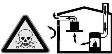
Los equipos calefactores que dependen del aire del recinto de instalación (p. ej., calefactores de gas, aceite, madera o carbón, calentadores de salida libre, calentadores de agua) adquieren aire de combustión del recinto de instalación y evacuan los gases de escape al exterior a través de un sistema extractor (p. ej., una chimenea).
