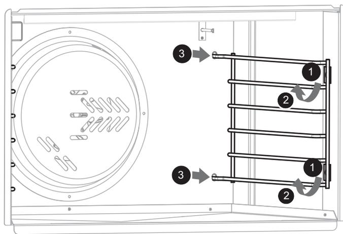
Figure 29 : Retrait des guides pour le nettoyage
