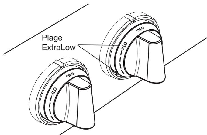
Figure 12 : Bouton de contrôle de brûleur ExtraLow
