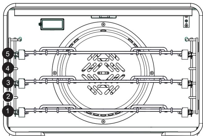
Figure 1 : Positions des grilles dans le grand four
