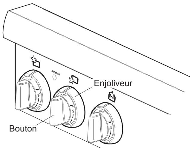
Figure 10 : Bouton de commande standard d'un brûleur
