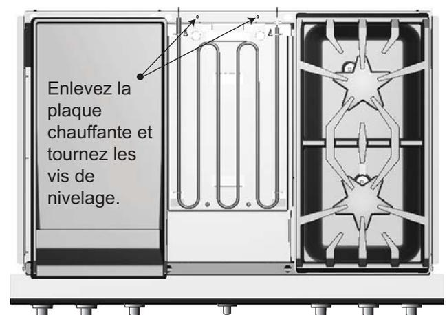
Figure 24 : Vis de nivelage de la plaque chauffante
