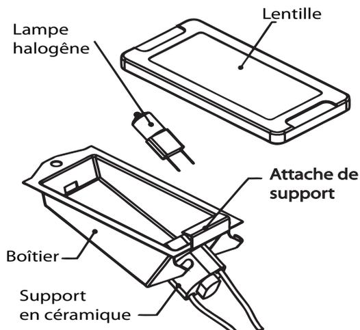
Figure 30 : Assemblage de la lampe du four
