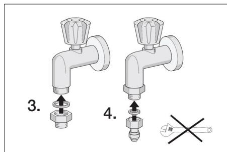
4. Подсоедините резьбовую муфту к водопроводному крану.
