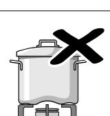
No utilice recipientes deformados que se muestren inestables sobre la placa de cocción. Los recipientes podrían volcar.
