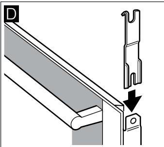
6. Установите защитную панель на место и закрепите её. Если винты защитной панели не вворачиваются, проверьте, правильно ли располагаются стёкла в держателе.
