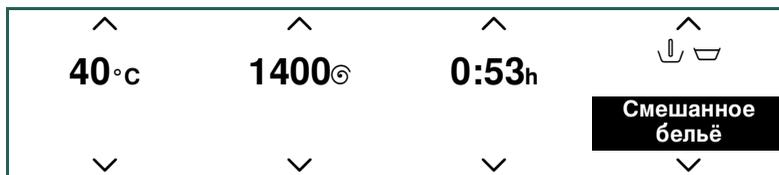
Введенную в память программу можно изменить с помощью кнопки под программой, пока видна стрелка.
