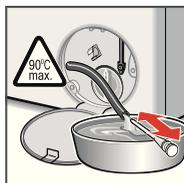
4. Снимите крышку, слейте моющий раствор в соответствующую емкость. Установите закрывающую пробку на место. Вставьте сливной шланг в держатель.
