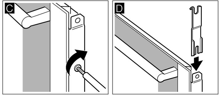
6. Abdeckung aufsetzen und anschrauben. Lässt sich die Abdeckung nicht anschrauben, prüfen ob die Scheiben richtig in der Halterung sitzen.
