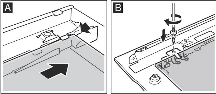
3. Scheibe in die Halterung am Backwagen einföhren.
