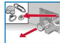
Para evitar que en el próximo lavado salga el detergente desperdiciado por el desagüe: Verter 2 litros de agua en el compartimento  **II**  e iniciar el programa ☹ (**desaguar**).
