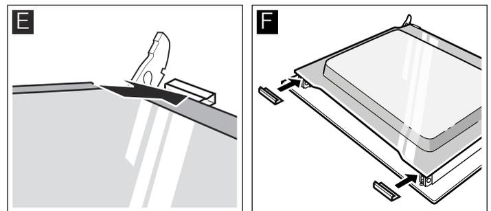
7. Abdeckung aufsetzen und anschrauben.
