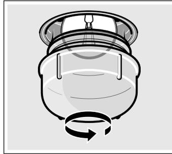
3. Lampe durch eine Lampe desselben Typs ersetzen.
