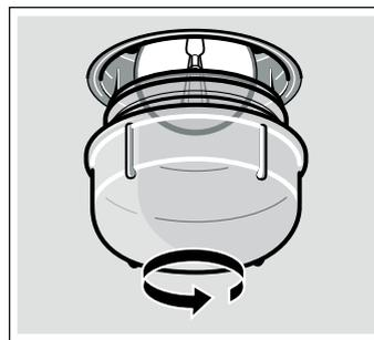
3. Lampe durch den gleichen Lampentyp ersetzen.
