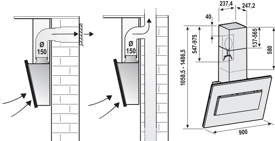
O ar viciado é evacuado para cima por meio de um tubo de descarga ou directamente para fora atravessando a parede.
