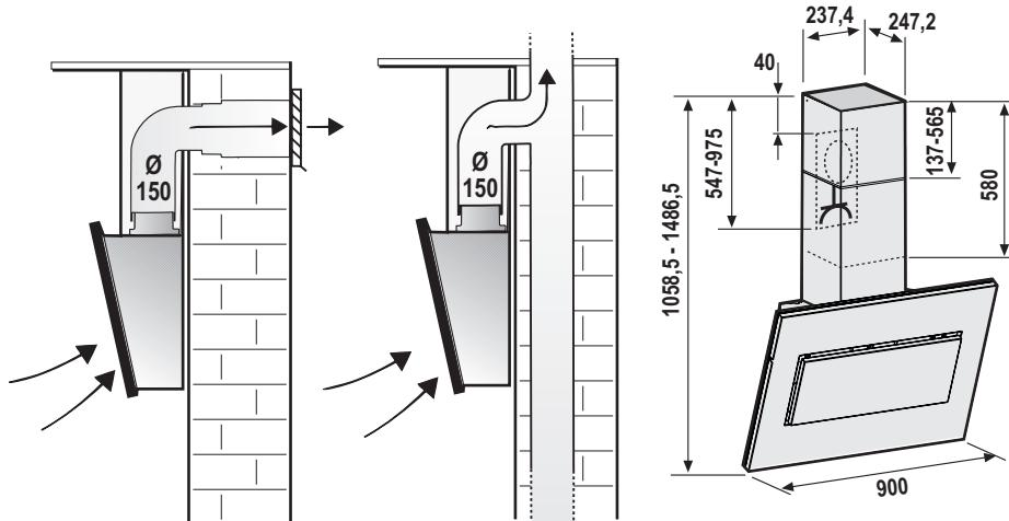
El aire viciado se evaca hacia arriba a través de un tubo de descarga o directamente hacia el exterior atravesando la mampostería.
