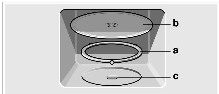
**Указание:** Используйте прибор со вставленной вращающейся подставкой. Проверьте, чтобы она была правильно зафиксирована. Вращающаяся подставка может вращаться как в левую, так и в правую стороны.
