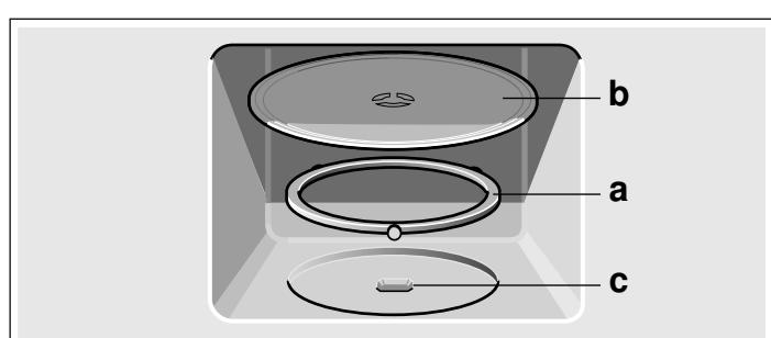
**Huomautus:** Käytä laitetta vain pyörivä lautanen paikalleen asennettuna. Varmista, että se on lukittunut oikein paikalleen. Pyörivä lautanen voi pyöriä sekä vasemmalle että oikealle.
