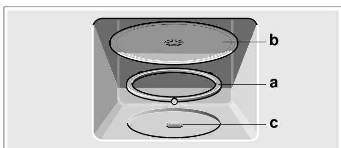
**Bemærk:** Anvend kun apparatet med indsæt drejetallerkenen. Kontroller, at den er gået korrekt i indgreb. Drejetallerkenen kan drejes både mod venstre og mod højre.
