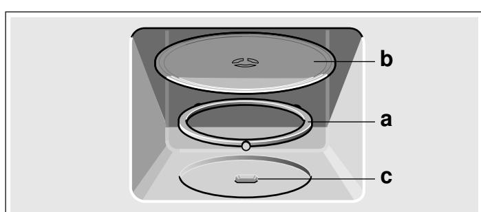
**Merk:** Apparatet må bare brukes når dreietallerkenen er satt inn. Kontroller at den er satt riktig på plass. Dreietallerkenen kan rotere mot høyre eller mot venstre.
