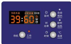
■热水器默认目标温度为60℃；按下“温度”键<3秒，每按一下，设定温度增加1℃；按下“温度”键≥3秒，显示屏右侧“88”在60℃~75℃, 35℃~60℃之间以5℃的倍数递增显示，松开按键后显示温度即为新的目标温度。松开按键5秒设定参数自动保存。
