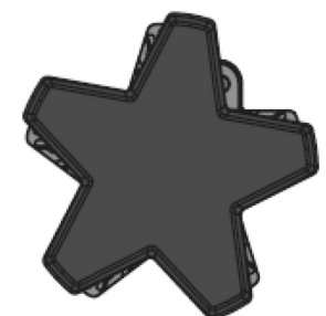
Positionnement incorrect de la cuvette du brûleur
