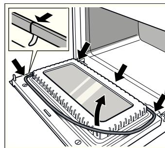
**Указание:** стык концов уплотнителя дверцы внизу посередине технологически обусловлен.
