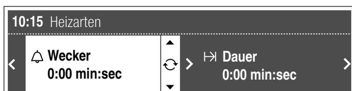
2. Mit Taste  $>$  oder  $<$  zur Dauer wechseln und mit dem Drehwähler die Dauer einstellen.
