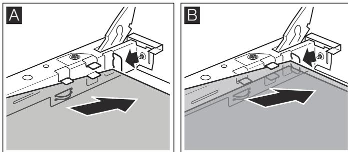
3. Halteklammern rechts und links auf die Scheibe stecken, ausrichten, dass die Federn über dem Schraubloch sind und festschrauben (Bild C).
