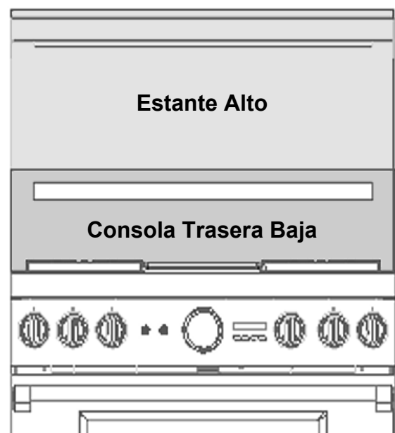
Figura 24: Vista frontal del estante y de la consola trasera baja
