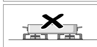
Kesinlikle bir tavayı ısıtmak için iki brülörü veya ısı kaynağı aynı anda kullanmayın.
