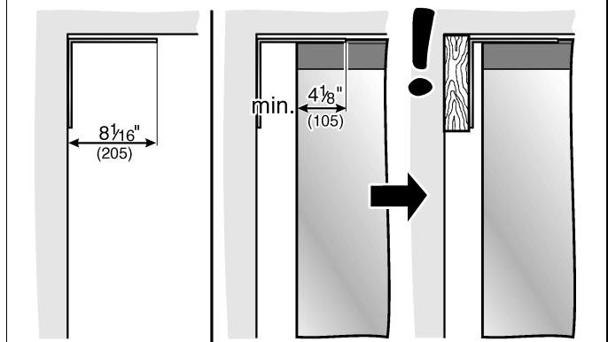
Il faudrait que la longueur de la planche corresponde à la largeur de la cavité d'installation !
