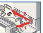
4. Limpiar el recinto interior de la bomba, la rosca de la tapa de la bomba y el cárter de la bomba.
