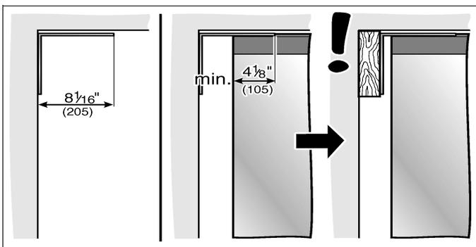
Pour retenir les appareils sûrement à la verticale, les cornières anti-renversement doivent les retenir par une longueur d'au minimum  $4\frac{1}{8}$ " (105 mm).
