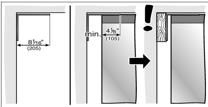
Los ángulos antivuelco deben presentar una longitud mínima sobre el electrodoméstico de  $4\frac{1}{8}$ " (105 mm) a fin de asegurar un emplazamiento seguro del equipo.
