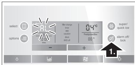
В течение 10 секунд дисплей показывает самую высокую температуру, которая устанавливалась в морозильном отделении. После чего на дисплей снова выводится заданная температура.
