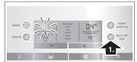
A indicação de temperatura apresenta durante 10 segundos a temperatura mais elevada que se verificou na zona de congelação. Depois volta a ser indicada a temperatura regulada.
