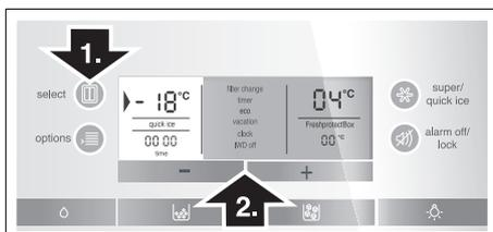
La temperatura del compartimento de congelación se puede ajustar de -14 °C hasta -24 °C.
