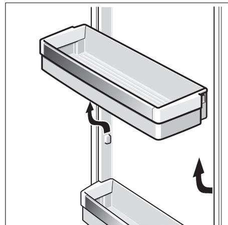
Полку можно приподнять и снять с двери.
