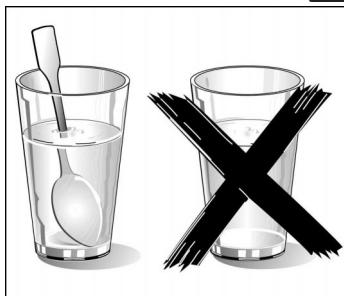
Når drikkevarer bliver opvarmet, kan der ske en forsinket kogning. Det betyder, at væsken bliver opvarmet til kogepunktet, uden at der som normalt dannes luftbobler. Ved den mindste rystelse af beholderen kan den varme væske pludselig koge over eller sprojete. Fare for forbrænding!
