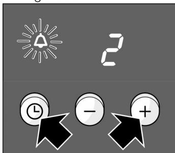
1. Pulsar simultáneamente la tecla de reloj  $\text{⌚}$  y la tecla + hasta que aparezca un  $\text{2}$  en el panel indicador. Esto es el ajuste básico para la duración de la señal.
