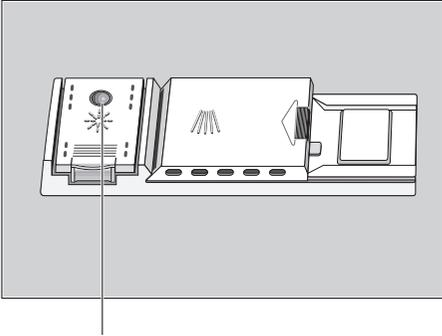
Piloto de aviso para la reposición del abrillantador
