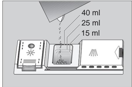
En caso de encontrarse cerrada la cámara del detergente [30], accionar primero la palanca de desbloqueo [28] para abrirla.
