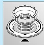
enroscar el filtro cilíndrico
