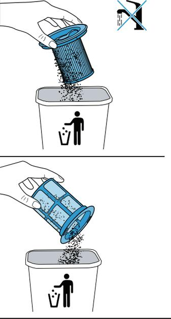
Lamellenfilter über einer Abfalltonne ausklopfen.
