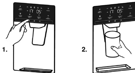
1. Pulsar la tecla o para activar el dispensador de hielo y agua en el modo de funcionamiento para cubitos de hielo o hielo picado. El indicador correspondiente o se ilumina cuando el modo de funcionamiento seleccionado está activo.
