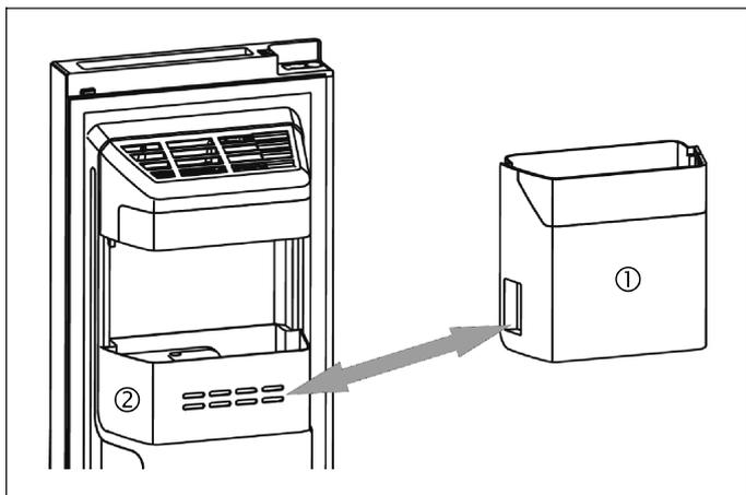
Si no se necesita hielo, se puede desconectar el fabricante de hielo y utilizar el recipiente de la puerta (2) en lugar del depósito de cubitos de hielo (1) para así disponer de más espacio en el congelador.
