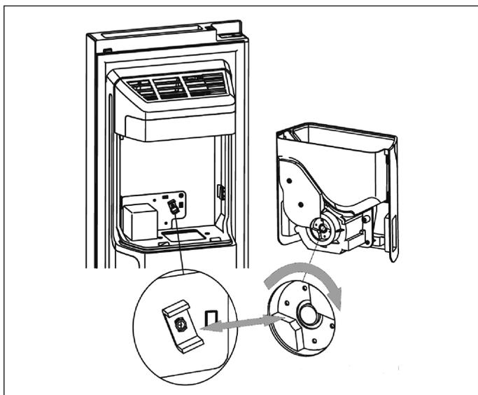
1. Asegurarse de que ambos acoplamientos se encuentren en un ángulo adecuado entre sí para poder engancharse. En caso necesario, girar el acoplamiento del depósito de cubitos de hielo para que se ajuste al acoplamiento del motor.
