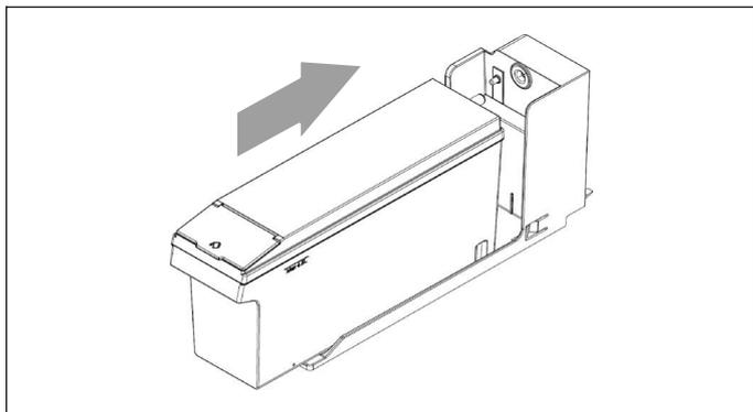
3. Volver a introducir el depósito correctamente.
