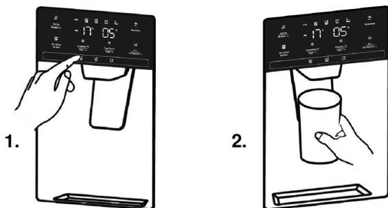
1. Pulsar la tecla para activar el dispensador de hielo y agua en el modo de funcionamiento para agua. El indicador se ilumina cuando el modo de funcionamiento para agua está activo.
