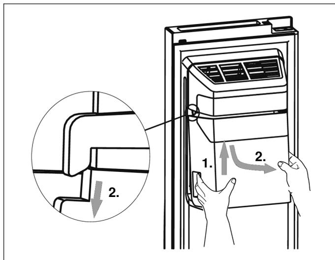
1. Sujetar el depósito para cubitos de hielo por el tirador y tirar hacia arriba.
