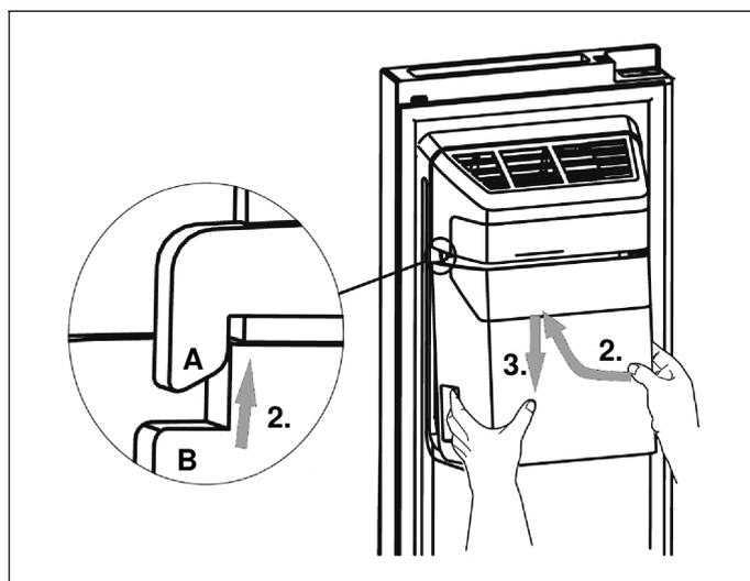
2. Sujetar el depósito para cubitos de hielo por el tirador y tirar hacia arriba. Asegurarse de que el depósito de cubitos de hielo (B) encaje a ambos lados de las abrazaderas (A) del fabricante de hielo.
