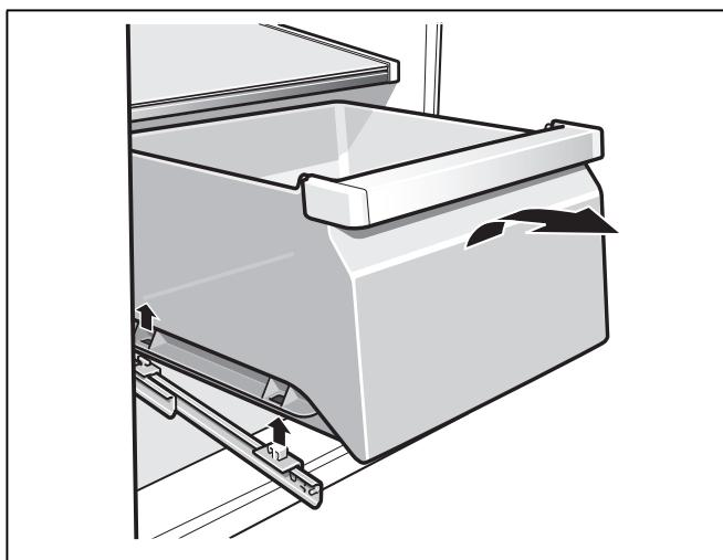
Para colocar el recipiente, ponerlo sobre los rieles telescópicos y empujarlo hacia el interior. Los cajones enclavan presionándolos hacia abajo.
