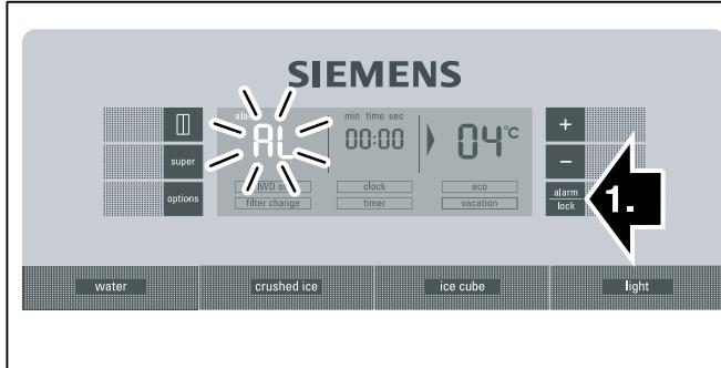
En la pantalla de visualización aparece durante 10 segundos la temperatura más elevada (calor) registrada en el compartimento de congelación, mostrándose a continuación la temperatura ajustada. La indicación «alarm» se apaga tan pronto como se vuelve a alcanzar la temperatura programada.
