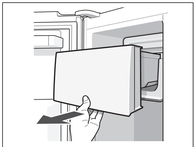
Após a limpeza, secar bem a gaveta e o sem-fim de transporte, para que os novos cubos de gelo não possam ficar agarrados por congelamento.
