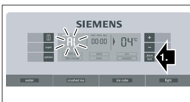
A indicação de temperatura mostra, durante 10 segundos, a temperatura mais alta que predominou na zona de congelação. Depois, volta a ser indicada a temperatura regulada.
