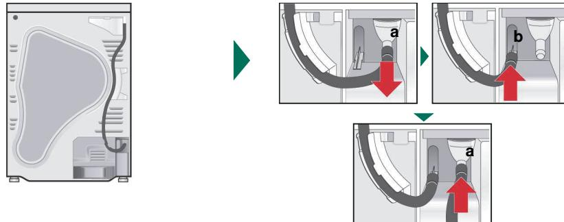
Uitleverstoand van de droogautomaat: de slang is voer de afvoer van het condenswater in het condenswaterreservoir op de aansluiting bevestigd.
