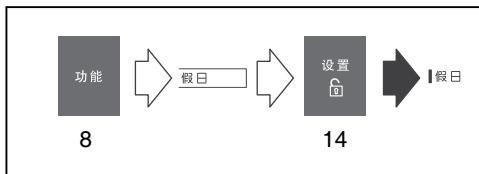
进入假日模式后,冷藏室显示 14°C,变温室显示 14°C,冷冻室仍保持在原来的温度设置下运行。此时的 [节能] 和 [自动] 模式只对冷冻室有效。
