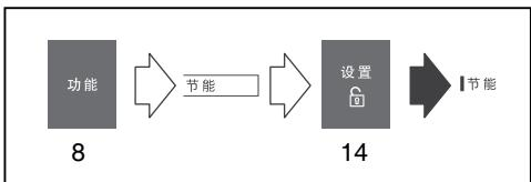
进入节能模式后,冷藏室显示 6℃,变温室显示 0℃,冷冻室显示 -16℃,制冷系统将自动在这样的温度设置下运行。
