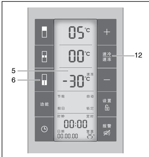
若一次性冷冻大量食品，应提前打开速冻功能，让冷冻室降至较低温度，再放入食品。
