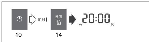
定时的时间默认为 20 分钟,显示区 9 显示剩余时间,20 分钟后,蜂鸣器开始发出报警声音。触摸报警按钮取消此功能和报警声音。
