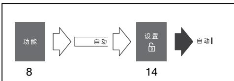
进入自动模式后,冷藏室显示 4℃,变温室显示 0℃,冷冻室显示 -18℃,制冷系统将自动在这样的温度设置下运行。
