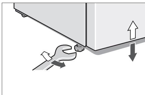
需要移动冰箱时，请先按逆时针方向调节塑料底脚，底脚离开地面后，再从冰箱的正面推动冰箱。
