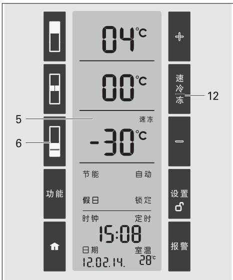
为快速冷冻新鲜食品，本产品设有速冻功能。触摸按钮 6，激活冷冻室显示区 5，再触摸速冻按钮 12，此时冷冻室显示区 5 将显示“速冻”字符，同时冷冻室温度显示 -30°C，表示速冻模式已开始运行，它能使待冷冻食品快速冷却，达到冷冻保鲜温度。
