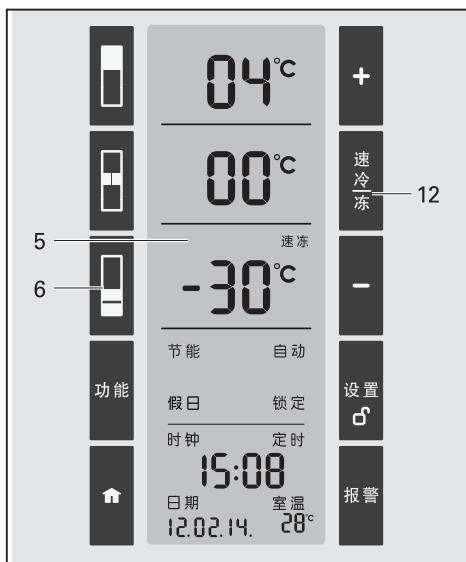
为快速冷冻新鲜食品，本产品设有速冻功能。触摸按钮 6，激活冷冻室显示区 5，再触摸速冻按钮 12，此时冷冻室显示区 5 将显示“速冻”字符，同时冷冻室温度显示 -30℃，表示速冻模式已开始运行，它能使待冷冻食品快速冷却，达到冷冻保鲜温度。
